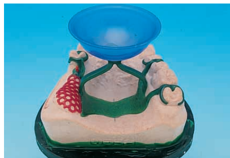
Пример: Литниковая система при вакуумном литье под давлением
